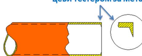
„зуб“ на крају реза након сечење цеви тестером за метал
