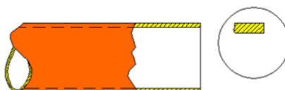
очишћена цев припремљена за претловање / лемење
