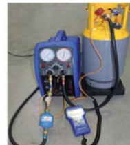
Повезивање цилиндра за сакупљање са заштитом од препуњавања
